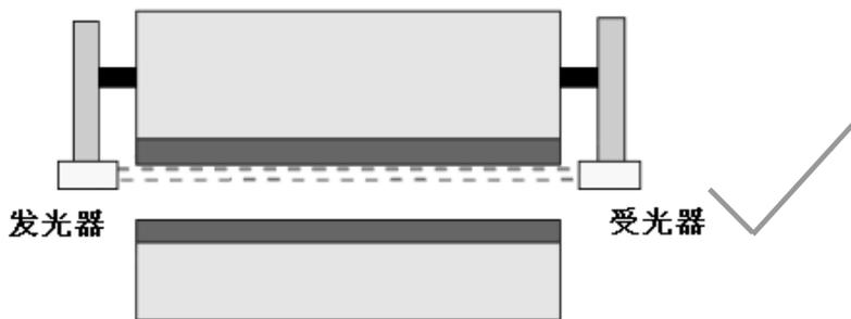
图 4-3 发光器与受光器正确安装位置
