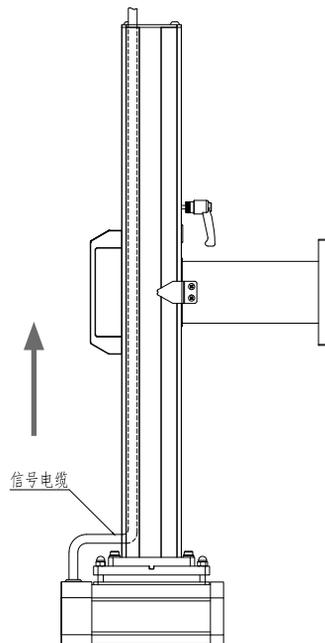
图 4-11 SLA-6 电缆线安装示意图
