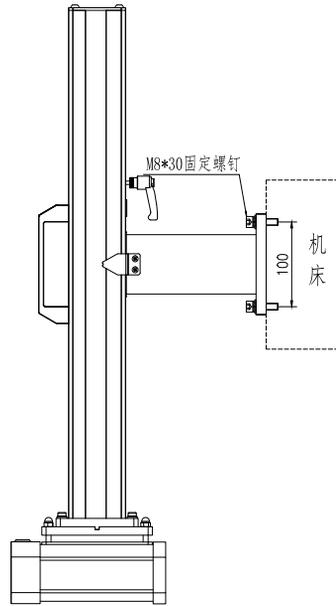
图 4-10 SLA-6 支架安装示意图 2
