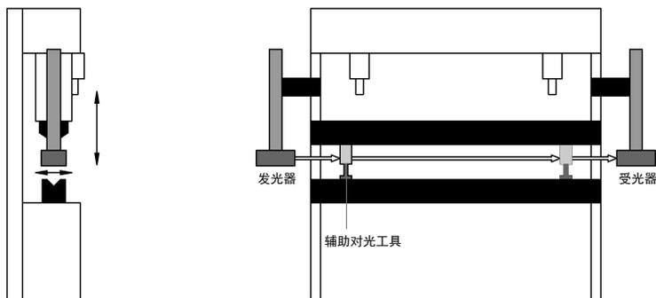
图 6-2 SLA-6 辅助对光示意图
