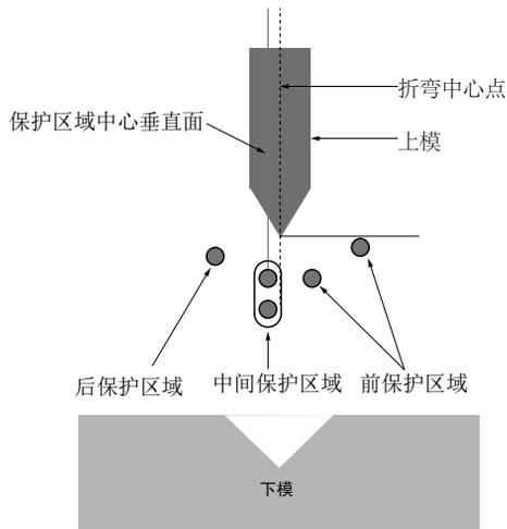
SLA-6 系列激光安全保护装置的保护区域分为三个不同的保护区域：一个前保护区域（朝向操作员）、一个中间保护区域（在上刀具尖端下方稍微朝着折弯机后部移动）和一个后保护区域（朝向折弯机后部）。
