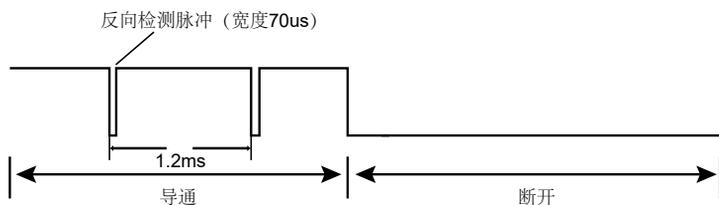
图2-5 PNP型安全输出波形图
