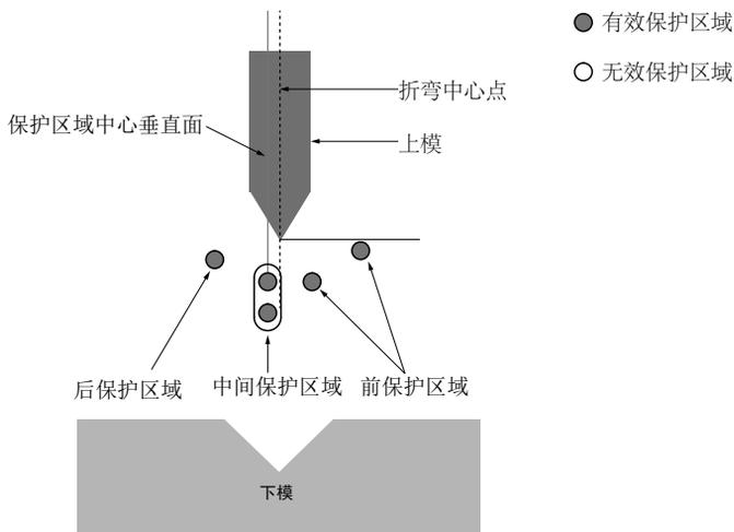
在进行折板操作时，选用此模式，这时光束全部有效，快下过程中，任何一束光被遮挡安全输出 OSSD1、OSSD2 断开。当有效光束被遮挡，踩下并释放脚踏后再次踩下脚踏开关，如果有效激光束还是被遮挡，安全输出信号保持断开，激光保护装置会输出强制慢下信号（PNP）。
