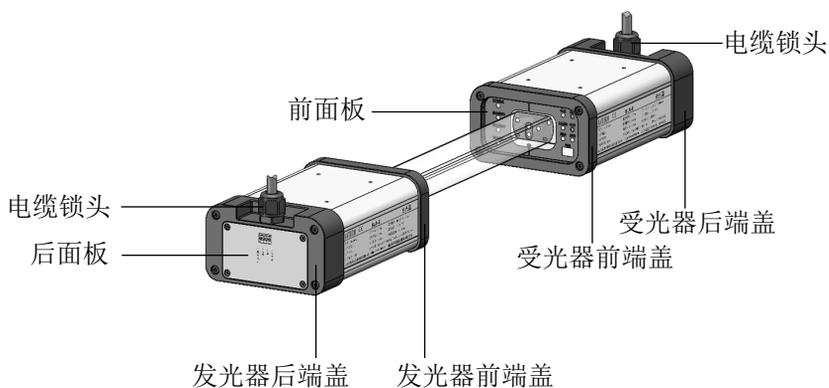
图3-2 SLA-6系列激光安全保护装置部件图
