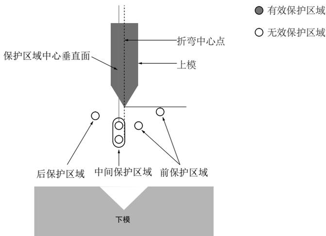
在抑制模式下，前保护区域、中间保护区域及后保护区域全部被抑制，不再起保护作用。
