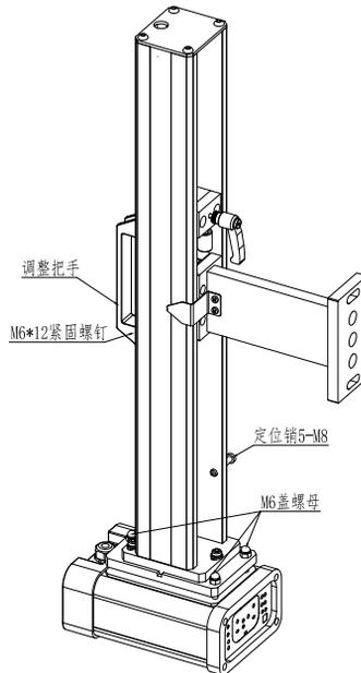
图 4-9 SLA-6 支架安装示意图 1
