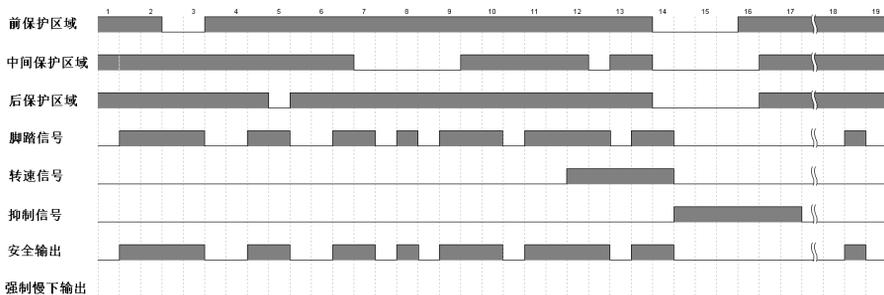
图2-4 抑制模式输出时序图
