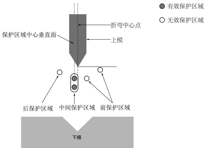
在进行折盒操作时，选用此模式。在此模式下中间保护区域光束全部有效，前保护区域光束及后保护区域光束被抑制，不再起保护作用。快下过程中，中间保护区域光束中任何一束光被遮挡，安全输出 OSSD1、OSSD2 断开。
