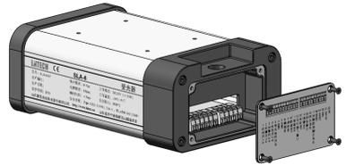
2. 将电缆线穿入 SLA-6 后端盖，并紧固电缆锁头；然后根据接线图 5-1 要求，将各信号线缆压入“压线端子”；电缆线压接完毕后，插紧“压线端子”。
