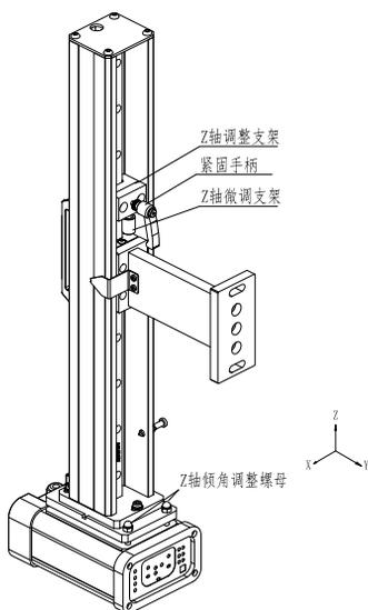
图 4-7 SLA-6 支架 Z 轴调整示意图
