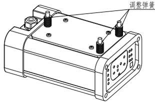
图 4-8 调整弹簧安装示意图
