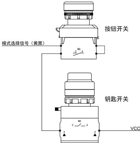
图 5-2 按钮开关及钥匙开关接线示意图
