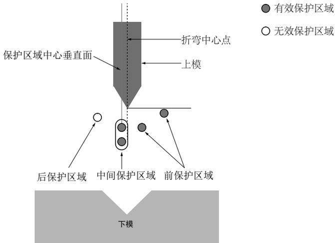
在进行折盒操作时，可以选用此模式。在此模式下前保护区域光束及中间保护区域光束全部有效，后保护区域光束被抑制，不再起保护作用。快下过程中，前保护区域光束及中间保护区域光束中任何一束光被遮挡，安全输出 OSSD1、OSSD2 断开。当有效光束被遮挡，踩下并释放脚踏后再次踩下脚踏开关，如果有效激光束还是被遮挡，安全输出信号保持断开，激光保护装置会输出强制慢下信号（PNP）。
